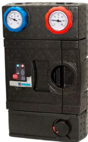
Grup de circulație cu vană de amestec, seria Flexi GRF Cu vană rotativă de amestec VRG132, livrat fără pompă, se poate monta orice pompă de 180mm. Livrat fără servomotor, se poate monta orice servomotor din seria ARA600 sau controler din seriile CRA, CRB, CRC sau CRD. Detalii la pagina 287.
