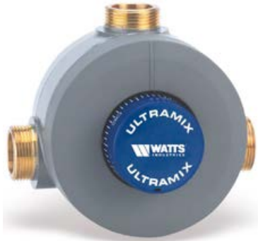
Ventil termostatic de amestec, seria Ultramix Ventile termostactice de amestec cu debite de până la 24mc/h, DN20...50mm. Gama de reglare 10...50°C sau 30...70°C. Detalii la pagina 274.
