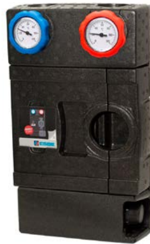
Grup de circulație temperatură fixă, seria Flexi GFF Cu ventil termostatic de amestec VTA572, livrat fără pompă, se poate monta orice pompă de 180mm. Detalii la pag. 286.
