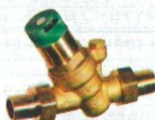
5) cod **D06F, D06FH, D06FI, D06FN, D06F-LFA, D06**, cu corp din alamă sau otel, manetă de reglaj prevăzută cu scală, filtru din otel cu ochiuri de **0,16 mm**, arc reglabil, diafragmă din NBR, având caracteristicile:
