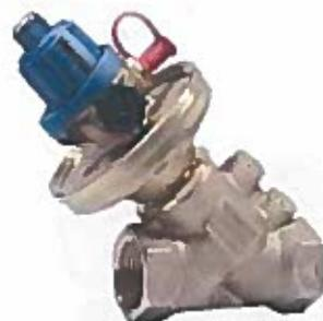
B). Vanele de echilibrare dinamica diferențială cu tub de impulsuri cu flanse, pentru reglarea presiunii diferențiale între tur și retur indiferent de variațiile dinamice pe circuitul deservit, cu corpul din fontă rezistență la coroziune, cu flanse pentru racordarea în instalație, cu presetare a reglajului în intervalele 30-60kPa, 40-200kPa, cu garnituri de etanșare, tip O-ring, din EPDM, sunt produse în varianta:
