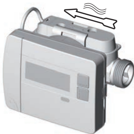
Монтаж горизонтально с наклоном
