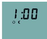
En pressant une fois la touche [ENTRÉE], l'heure de régénération est validée et l'affichage passe au mode de réglage du type de sel utilisé.
