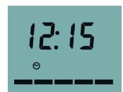
La pressione singola del tasto [IMPOSTA] immette i minuti e commuta il display in modalità di impostazione della durezza. Questa è visualizzabile in ppm, gradi tedeschi o gradi francesi a seconda del modello di addolcitore.
