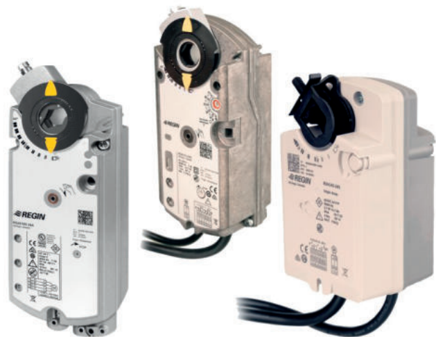
Servomotoare de jaluzele, seria RDAS...S 24V sau 230Vca. On/off sau 0...10V, cu resort arc. Cuplu 4, 7 și 18Nm. Cu sau fără contacte auxiliare. Înlocuiește seria RDAB...S. Detalii la pagina 141.
