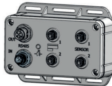
Convertor de semnal Modbus în 2x 0...10V Intrare și ieșire RS485 Modbus RTU, două ieșiri 0...10V, două intrări pentru traductoare 4...20mA. Detalii la pagina 153.
