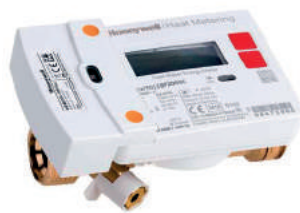
Contoare ultrasonice de energie, seria EW701 Contoare compacte de energie termică, ultrasonice. DN15-20mm. Interfață de comunicație standard IrDA și opțional M-Bus sau RF AMR/Walk-By C-Mode. Livrate cu senzor de tur și de încorporat de retur. Detalii la pagina 274
